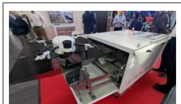
ニプソンイノベーションベースで紹介された YETI は、DroneMatrix のドローンインアボックスソリューションです。YETI ドローンと YEDO ドッキングステーションで構成されるこのソリューションは、気候制御された環境を備えており、天候やその他の環境条件からドローンを保護します。伸縮可能なファンネルは、この製品の最もユニークな機能で、YETI ドローンが正しい方向に自律的に着陸できるようにするために作されました。幅広い用途で使用できるように設計された YETI は、ユーザーに違いをもたらしましたが、これはこの製品がさらに実現しようとしている価値のほんの始まりにすぎません。
