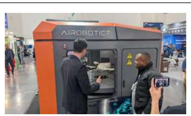
展示されていた Iron Drone システムは、非常に小型のドローン イン ア ボックス ソリューションで、まったく異なる目的のために開発されました。複雑な環境で敵対的なドローンから資産を守るために設計された Iron Drone システムは、状況に応じて敵対的なターゲットを迎撃し、無効にできる対ドローン ソリューションです。
