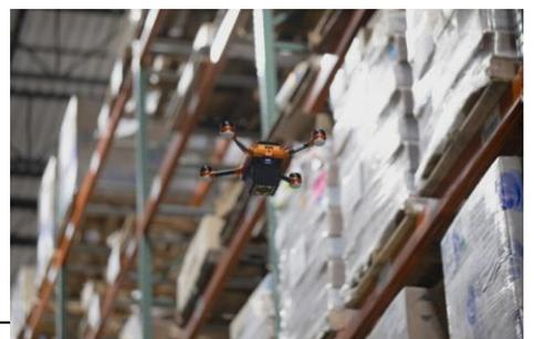
して環境を見て理解するためのカスタム光学系で設計された 14 台のカメラが装備されている。ビーコン、リフレクター、マーカ、ステッカー、さらには倉庫内を移動するためのローカリゼーションに WiFi は必要でない。手持ちのカメラとフリードから提供されたデータを使用して学習を行っているだけである。
