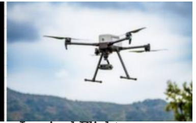
Inspired Flight IF800 飛行 54 分、3kg RTK/PPK cm.精度
