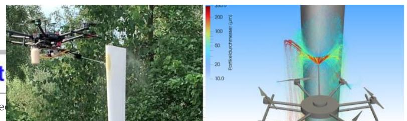
湿気の多い寒い環境は風力発電の敵です。ローターブレードに氷の層が形成されると、回転のバランスが崩れ、摩耗が増加する可能性がある。このような場合、タービンを数日間停止しなければならないことが多く、発電が一時停止するため、オペレーターに多大な損失をもたらす。今回、フラウンホーファーのチームは、ドローンを使ってローターブレードを氷から守ることに初めて成功した。
