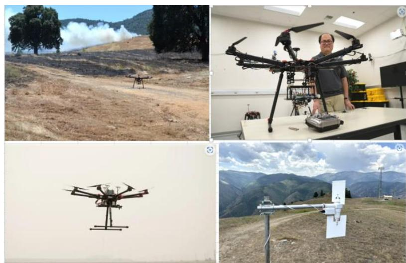
超乾燥した土壌、高温、強風という3つの脅威が検出されると、UAVはカメラと化学センサーのペイロードとともに送信され、空気中の粒子状物質や二酸化炭素の発生率の上昇など、火災のさらなる兆候のためにエリアを掃討し、調査結果を CalFire に報告する。
