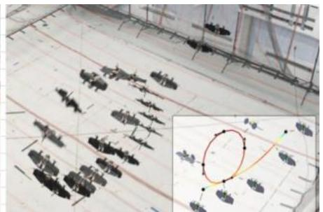
MIT は、テールシッタードローンでより複雑な操縦機能を可能にする新しいアルゴリズムを研究している。垂直に離着陸し、水平に傾いて前進する固定翼航空機です。クワッドコプタードローンよりも高速で効率的。かつホバリングできるため、捜索救助や小包配達などのタスクに適している。
